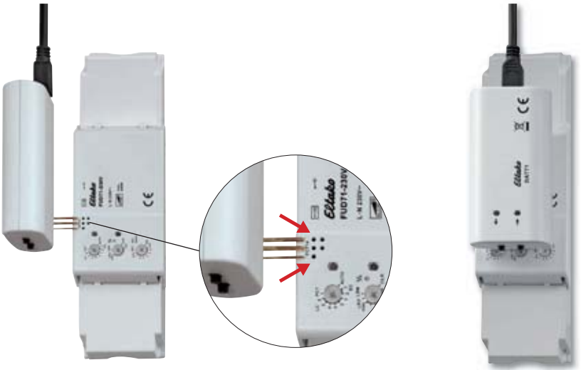
Collegamento del trasformatore dati DAT71 ad un attuatore Serie 71.
